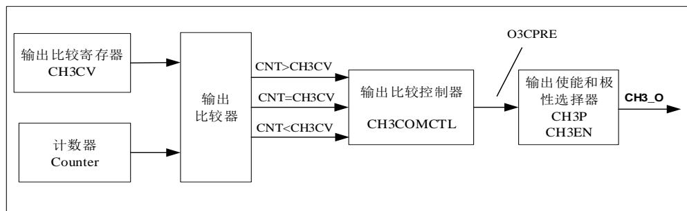
[图 18-13. 输出比较原理（带有互补输出的通道， \$x=0,1,2\$ ）](#) 和 [图 18-14. 输出比较原理](#) 分别给出了输出比较的逻辑电路。通道输出信号  $CHx\_O/CHx\_ON$  与  $OxCPRE$  信号（详情请见[通道输出准备信号](#)）的关系描述如下： $OxCPRE$  信号高电平有效， $CHx\_O/CHx\_ON$  的输出情况与  $OxCPRE$  信号， $CHxP/CHxNP$  位和  $CHxEN/CHxNEN$  位有关（具体情况请见  $TIMERx\_CHCTL2$  寄存器中的描述）。例如：
