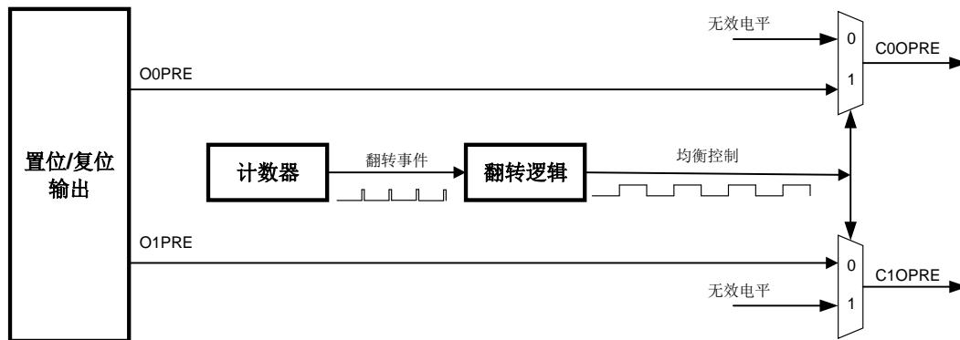
一旦接收到翻转事件，翻转逻辑模块的输出就会翻转。当翻转逻辑模块的输出为 1（高电平）时，C0OPRE 连接到 O0PRE，C1OPRE 为无效电平（低电平）。当翻转逻辑模块的输出为 0（低电平）时，C1OPRE 连接到 O1PRE，C0OPRE 为无效电平（低电平）。
