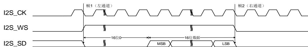
图 22-34. LSB 对齐标准时序图 (DTLEN=00, CHLEN=1, CKPL=1)
