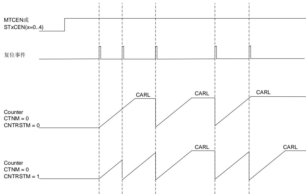
在连续模式下，一旦 SHRTIMER\_MTCTL0 寄存器中的 MTCEN 位置 1，计数器将立即启动。当计数到计数器重载值时，计数器从 0 重新启动，并产生翻转事件。与单脉冲模式不同，随时生成的复位事件将复位并重启计数器。[图 19-5. 连续模式下计数器的动作](#)展示了连续模式下的计数器运行情况。
