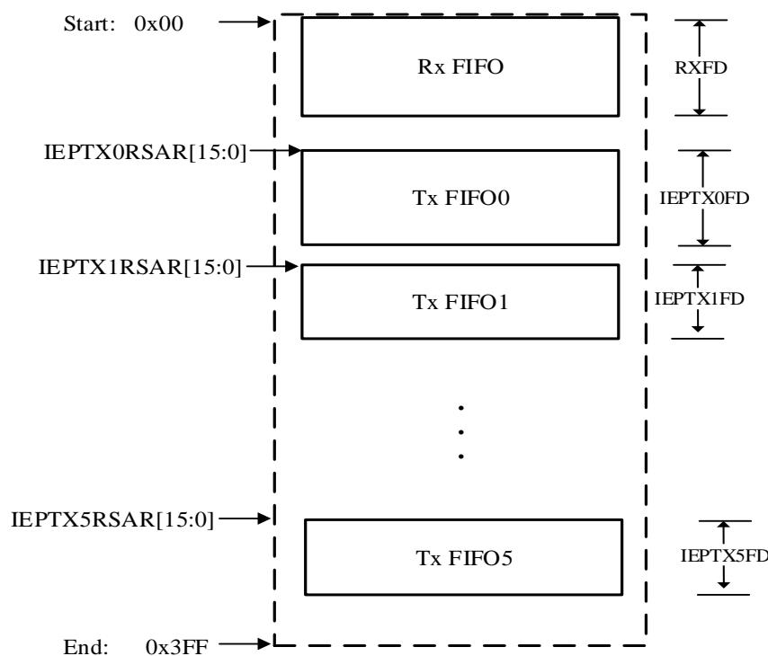
在 DMA 模式下，DMA 负责系统存储区和数据 FIFO 之间的数据包传输。在非 DMA 模式下，程序将包数据写入数据 FIFO 或从数据 FIFO 读取包数据。USBHS 为程序提供了专有寄存器空间来读写数据 FIFO。[图 29-9. 设备模式 FIFO 访问寄存器映射表](#)所描述的是数据 FIFO 所访问的寄存器存储空间，图中的数值是以字节为单位寻址。每个端点都拥有它们的 FIFO 访问寄存器空间。通过寄存器 USBHS\_GRXTATTR/USBHS\_GRSTATP 来访问 Rx FIFO。
