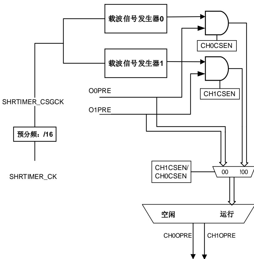
载波信号模式中，可以在载波信号开始之前定义一个特定的脉冲宽度。载波信号的频率和占空比是可配置的。详见[图 19-37. 载波模式使能时的 SHRTIMER 输出](#)。
