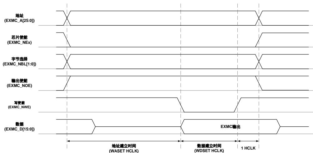
模式A和模式1的区别在于写时序，当两个模式的寄存器有相同的时序配置时，模式A的写时序独立于读时序。
