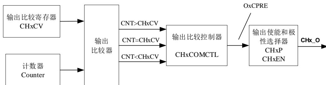
[图 18-39. 输出比较原理 \( \$x=0,1,2,3\$ \)](#) 给出了输出比较的原理电路。通道输出信号 CHx\_O 与 OxCPRE 信号（详情请见[通道输出准备信号](#)）的关系描述如下：OxCPRE 信号高电平有效，CHx\_O 的输出情况与 OxCPRE 信号，CHxP 位和 CHxEN 位有关（具体情况请见 TIMERx\_CHCTL2 寄存器中的描述）。例如，当设置 CHxP=0 (CHx\_O 高电平有效，与 OxCPRE 输出极性相同)、CHxEN=1 (CHx\_O 输出使能) 时：
