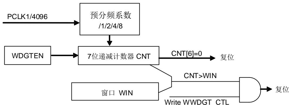
上电复位之后窗口看门狗定时器总是关闭的。软件可以向WWDGT\_CTL的WDGTEN写1开启窗口看门狗定时器。窗口看门狗定时器打开后，计数器始终递减计数，计数器配置的值应该大于0x3F，也就是说CNT[6]位应该被置1。CNT[5:0]决定了两次重装载之间的最大间隔时间。计数器的递减速度取决于APB1时钟和预分频器 (WWDGT\_CFG寄存器的PSC[1:0]位)。
