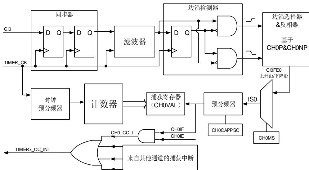
通道输入信号  $\text{CI}x$  先被  $\text{TIMER\_CK}$  信号同步，然后经过数字滤波器采样，产生一个被滤波后的信号。通过边沿检测器，可以选择检测上升沿或者下降沿。通过配置  $\text{CH}x\text{P}$  选择使用上升沿或者下降沿。配置  $\text{CH}x\text{MS.}$ ，可以选择其他通道的输入信号，内部触发信号。配置 IC 预分频器，使得若干个输入事件后才产生一个有效的捕获事件。捕获事件发生， $\text{TIMERx\_CH}x\text{CV}$  存储计数器的值。
