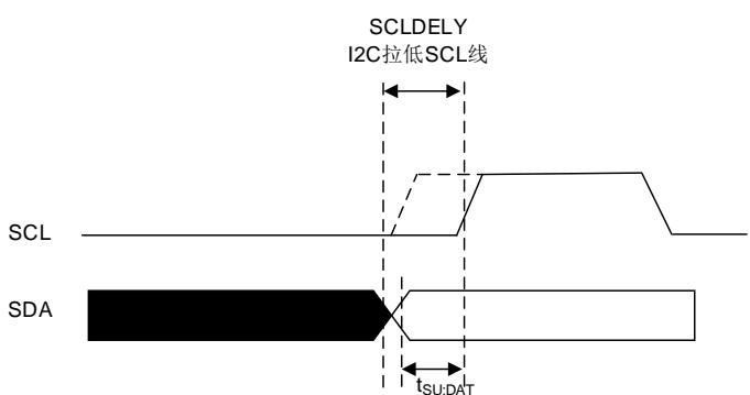
当内部检测到 SCL 下降沿时，在 SDA 发送之前会插入一个延时。该延时为  $t_{SDADELY} = SDADELY * t_{PSC} + t_{I2CCLK}$ ，其中  $t_{PSC} = (PSC + 1) * t_{I2CCLK}$ 。 $t_{SDADELY}$  影响  $t_{HD;DAT}$ 。SDA 输出总延时为  $t_{SYNC1} + \{ [SDADELY * (PSC + 1) + 1] * t_{I2CCLK} \}$ 。 $t_{SYNC1}$  由 SCL 下降斜率，模拟滤波器延时，数字滤波器延时和 SCL 与 I2CCLK 时钟的同步延时共同决定。SCL 与 I2CCLK 时钟的同步延时为 2 至 3 个  $t_{I2CCLK}$ 。
