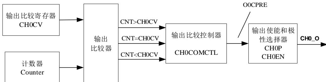
**图 18-66. 通道输出比较原理**给出了输出比较的逻辑电路。通道输出信号  $\text{CH}_x\text{O}$  与  $\text{O}_x\text{CPRE}$  信号（详情请见[通道输出准备信号](#)）的关系描述： $\text{O}_x\text{CPRE}$  信号高电平有效， $\text{CH}_x\text{O}$  的输出情况与  $\text{O}_x\text{CPRE}$  信号， $\text{CH}_x\text{P}$  位和  $\text{CH}_x\text{EN}$  位有关（具体情况请见 **TIMERx\_CHCTL2** 寄存器中的描述）。例如，当设置  $\text{CH}_x\text{P}=0$  ( $\text{CH}_x\text{O}$  高电平有效，与  $\text{O}_x\text{CPRE}$  输出极性相同)、 $\text{CH}_x\text{EN}=1$  ( $\text{CH}_x\text{O}$  输出使能) 时：
