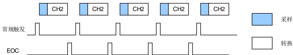
常规通道单次转换结束后，转换数据将被存放于ADC\_RDATA寄存器中，EOC将会置1。如果EOCIE位被置1，将产生一个中断。
