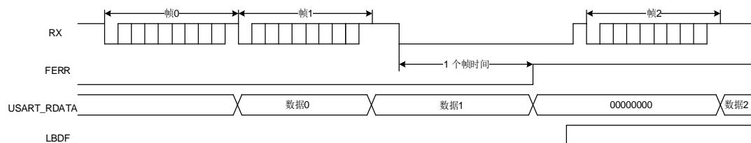
如 [图 20-24. 数据传输过程中检测断开帧](#) 所示，如果断开帧发生在数据传输过程中，当前传输帧发生错误，FERR 置位。
