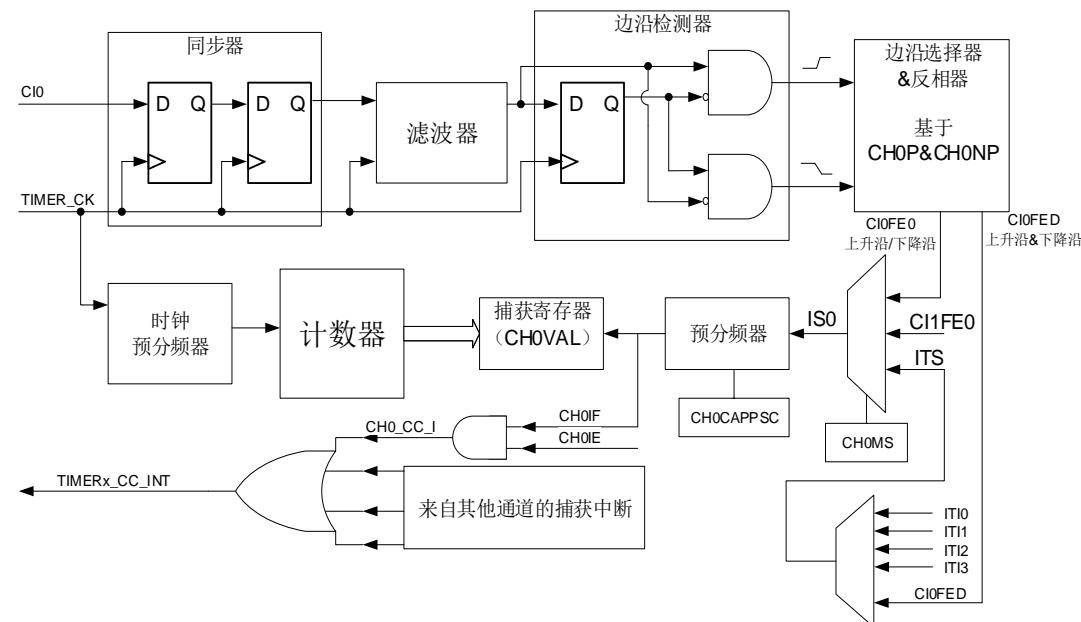
通道输入信号 **Clx** 先被 **TIMER\_CK** 信号同步，然后经过数字滤波器采样，产生一个被滤波后的信号。通过边沿检测器，可以选择检测上升沿或者下降沿。通过配置 **CHxP** 选择使用上升沿或者下降沿。配置 **CHxMS.**，可以选择其他通道的输入信号，内部触发信号。配置 IC 预分频器，使得若干个输入事件后才产生一个有效的捕获事件。捕获事件发生，**TIMERx\_CHxCV** 存储计数器的值。
