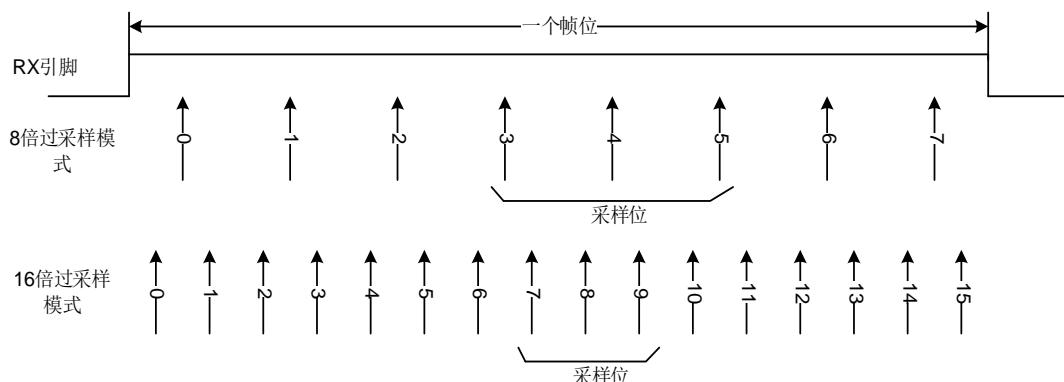
通过置位 **USART\_CTL0** 寄存器中的 **PCEN** 位使能奇偶校验功能, 接收器在接收一个数据帧时计算预期奇偶校验值, 并将其与接收到的奇偶校验位进行比较。如果不相等, **USART\_STAT** 寄存器中 **PERR** 被置位。如果置位了 **USART\_CTL0** 寄存器中的 **PERRIE** 位, 将产生中断。
