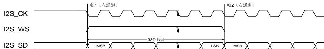
图 22-27. MSB 对齐标准时序图 (DTLEN=01, CHLEN=1, CKPL=0)
