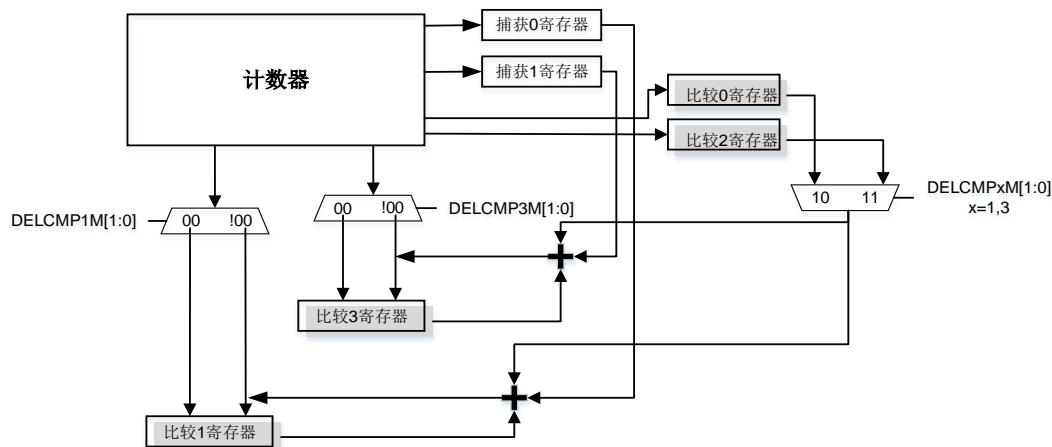
在延迟模式下, 比较  $y$  ( $y = 1, 3$ ) 事件从相应的捕获/比较事件发生到周期事件期间有效。当计数器达到周期值时, 将禁用比较  $y$  ( $y = 1, 3$ ) 事件, 直到出现新的捕获/比较事件。
