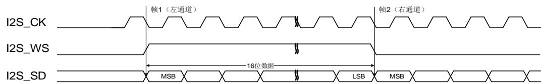
图 22-24. MSB 对齐标准时序图 (DTLEN=00, CHLEN=0, CKPL=1)
