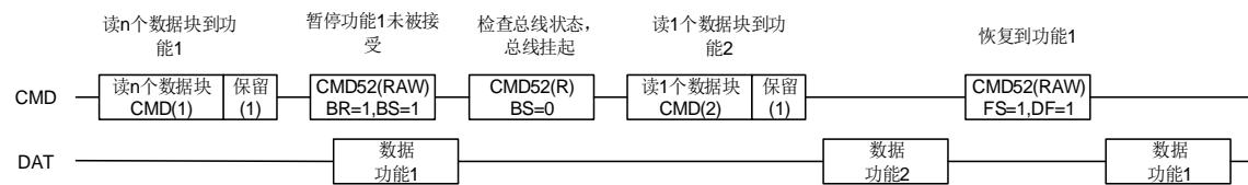
当主机向卡发送数据时，主机可以暂停写操作。设置 SDIO\_CMDCTL[11]位并指示 CSM 当前的命令是一个暂停命令。CSM 分析响应，当从卡收到响应时(暂停被接受)，它确认 DSM 在收到当前数据块的 CRC 后进入空闲状态。
