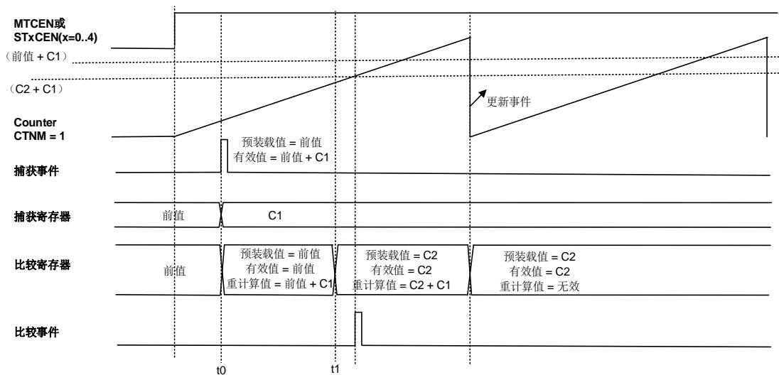
使用延迟模式 (DELCMP3M [1:0] = 01, 10,11)，可以防止捕获溢出发生。在同一个计数周期（由SHRTIMER\_STxCAR确定）内，仅考虑第一个捕获事件。新的捕获事件在以下三种情况下有效：
