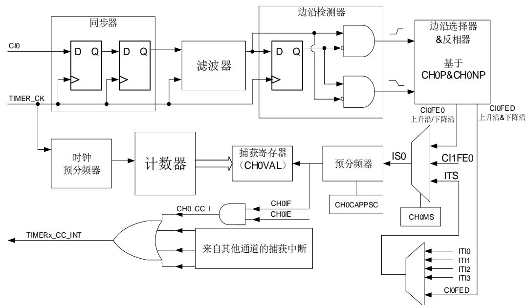
通道输入信号  $\text{Clx}$  有两种选择，一种是  $\text{TIMERx\_CHx}$  信号，另一种是  $\text{TIMERx\_CH0}, \text{TIMERx\_CH1}$  和  $\text{TIMERx\_CH2}$  异或之后的信号。通道输入信号  $\text{Clx}$  先被  $\text{TIMER\_CK}$  信号同步，然后经过数字滤波器采样，产生一个被滤波后的信号。通过边沿检测器，可以选择检测上升沿或者下降沿。通过配置  $\text{CHxP}$  选择使用上升沿或者下降沿。配置  $\text{CHxMS.}$ ，可以选择其他通道的输入信号，内部触发信号。配置 IC 预分频器，使得若干个输入事件后才产生一个有效的捕获事件。捕获事件发生， $\text{TIMERx\_CHxCV}$  存储计数器的值。
