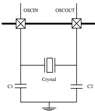
HXTAL晶体振荡器可以通过设置控制寄存器RCU\_CTL的HXTALEN位来启动或关闭，在控制寄存器RCU\_CTL中的HXTALSTB位用来指示外部高速振荡器是否已稳定。在启动时，直到这一位被硬件置‘1’，时钟才被释放出来。这个特定的延迟时间被称为振荡器的启动时间。当HXTAL时钟稳定后，如果在中断寄存器RCU\_INT中的相应中断使能位HXTALSTBIE位被置‘1’，将会产生相应中断。此时，HXTAL时钟可以被直接用作系统时钟源或者PLL输入时钟。
