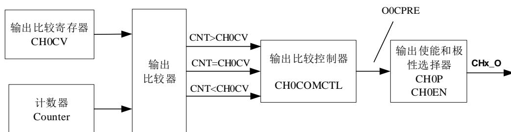
**图 18-53. 通道输出比较原理 ( $x=0, 1$ )** 给出了输出比较的逻辑电路。通道输出信号 CHx\_O 与 OxCPRE 信号（详情请见 [通道输出准备信号](#)）的关系描述：OxCPRE 信号高电平有效，CHx\_O 的输出情况与 OxCPRE 信号，CHxP 位和 CHxE 位有关（具体情况请见 TIMERx\_CHCTL2 寄存器中的描述）。例如，当设置 CHxP=0 (CHx\_O 高电平有效，与 OxCPRE 输出极性相同)、CHxEN=1 (CHx\_O 输出使能) 时：
