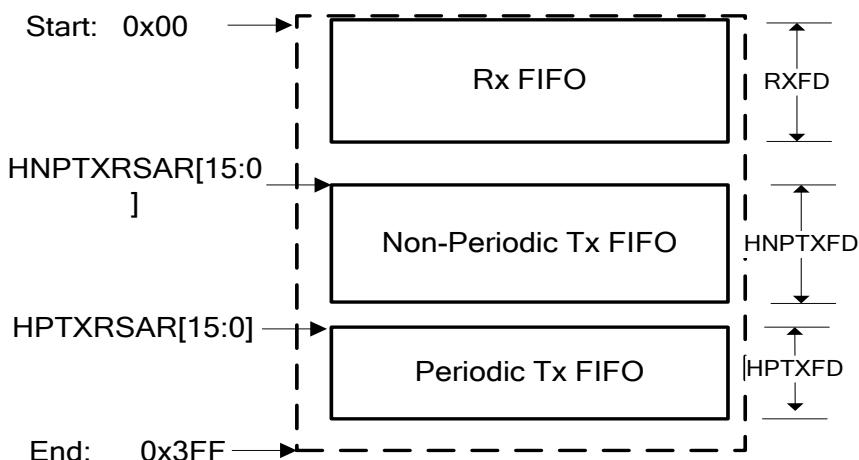
在 DMA 模式下，DMA 负责系统存储区和数据 FIFO 之间的数据包传输。在非 DMA 模式下，程序将包数据写入数据 FIFO 或从数据 FIFO 读取包数据。USBHS 为程序提供了专有寄存器空间来读写数据 FIFO。[图 29-7. 主机模式 FIFO 访问寄存器映射表](#)所描述的是数据 FIFO 所访问的寄存器存储空间，图中的数值是以字节为单位寻址。尽管所有的非周期通道共享相同的 FIFO 以及所有的周期通道共享相同的 FIFO，每个通道都拥有它们的 FIFO 访问寄存器空间。对 USBHS 而言，获知当前压入数据包的通道号是非常重要的，通过寄存器 USBHS\_GRXTATTR/USBHS\_GRSTATP 来访问数据包所从属的 Rx FIFO。
