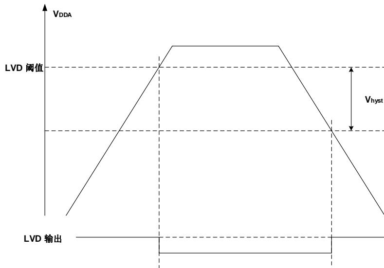
一般来说，数字电路由  $V_{DD}$  供电，而大多数的模拟电路由  $V_{DDA}$  供电。为了提高 ADC 和 DAC 的转换精度，为  $V_{DDA}$  独立供电可使模拟电路达到更好的特性。为避免噪声， $V_{DDA}$  通过外部滤波电路连接至  $V_{DD}$ ，相应的  $V_{SSA}$  通过特定电路连接至  $V_{SS}$ 。否则，当  $V_{DD}$  和  $V_{DDA}$  不是同一个电源提供时，在上电和运行过程中  $V_{DD}$  与  $V_{DDA}$  差值不超过 0.3V。
