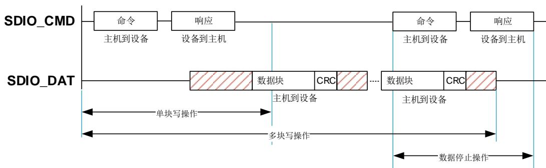
SD 存储卡、SD I/O 卡（包括仅 IO 卡和组合卡）和 CE-ATA 设备直接的数据传输是以数据块的方式完成的。MMC 卡以数据块或数据流方式进行数据传输。[图 24-4. SDIO 数据流读操作](#) 和 [图 24-5. SDIO 数据流写操作](#) 分别是数据流的读和写操作。
