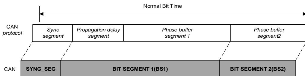
再同步补偿宽度SJW（resynchronization Jump Width）对CAN网络节点同步误差进行补偿，占用1到4个时间单元。
