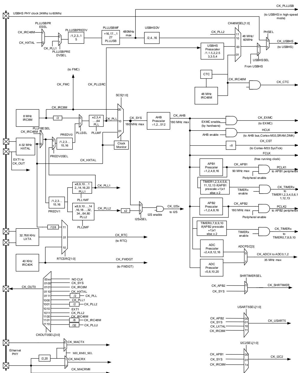
预分频器可以配置 AHB、APB2 和 APB1 域的时钟频率。AHB、APB2、APB1 域的最高时钟频率分别为 180MHz、180MHz、90MHz。RCU 通过 AHB 时钟 (HCLK) 8 分频后作为 Cortex® 系统定时器 (SysTick) 的外部时钟。通过对 SysTick 控制和状态寄存器的设置，可选择上述时钟或 AHB (HCLK) 时钟作为 SysTick 时钟。
