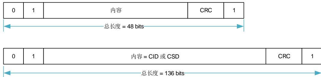
响应总是从一个起始位（始终为 0）开始，随后第二位表示传输的方向（卡=0）。下面表中的“x”的值表示为可变的部分。除了 R3 类型的所有响应由 CRC 校验。每个响应字段由结束位（总是 1）终止。
