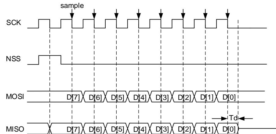
在从机TI模式中，在SCK信号的最后一个上升沿，从机开始发送最后一个字节的LSB位，在半位的时间之后，主机开始采集数据。为了确保主机采集到正确的数据，在释放该引脚之前，从机需要在SCK信号的下降沿之后继续驱动该位一段时间，这段时间称为T<sub>d</sub>，T<sub>d</sub>通过SPI\_CTL0寄存器中的PSC[2:0]位来设置。
