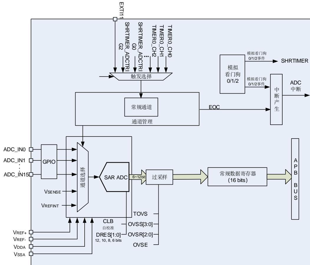
图 13-2. ADC 模块框图 (ADC2)
