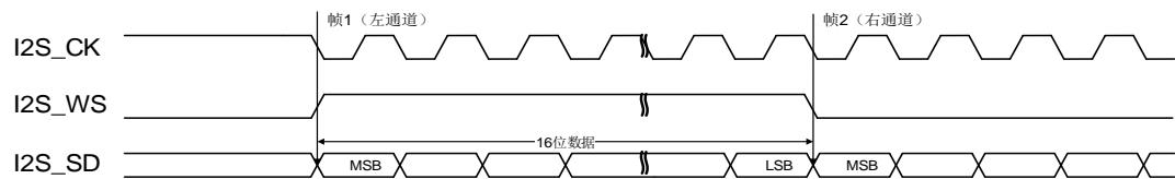
图 22-25. MSB 对齐标准时序图 (DTLEN=10, CHLEN=1, CKPL=0)
