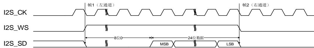
图 22-32. LSB 对齐标准时序图 (DTLEN=01, CHLEN=1, CKPL=1)
