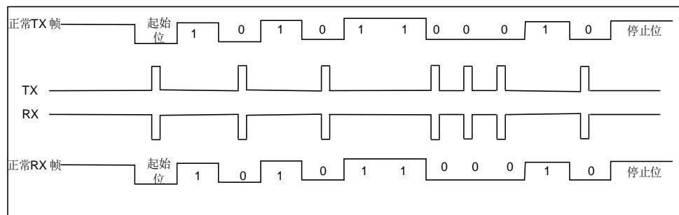
将 USART\_CTL2 寄存器中 IRLP 置位可以使 SIR 子模块工作在低功耗模式下。发送编码器由 PCLK 分频得到的低速时钟来驱动。分频系数在 USART\_GP 寄存器中 PSC[7:0] 位配置。TX 引脚脉冲宽度可以为低功耗波特率的 3 倍。接收解码器工作模式与正常 IrDA 模式相同。
