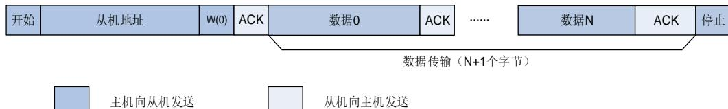
图 21-19. 7 位地址的 I2C 通讯流程（主机接收）
