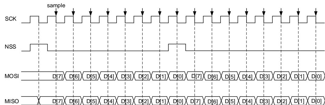
在主机TI模式下，SPI模块可实现连续传输或者不连续传输。如果主机写SPI\_DATA的速度很快，那么就是连续传输，否则，为不连续传输。在不连续传输中，在每个字节传输前需要一个额外的时钟周期。在连续传输中，额外的时钟周期只存在于第一个字节之前，随后字节的起始时钟周期被前一个字节的最后一一位的时钟周期覆盖。
