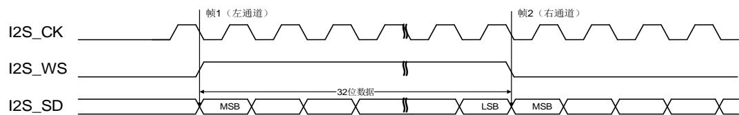
图 22-26. MSB 对齐标准时序图 (DTLEN=10, CHLEN=1, CKPL=1)
