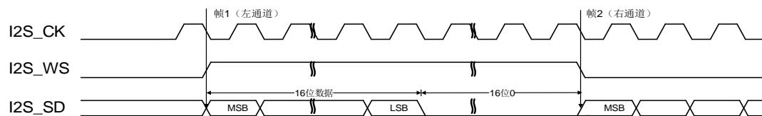
图 22-30. MSB 对齐标准时序图 (DTLEN=00, CHLEN=1, CKPL=1)
