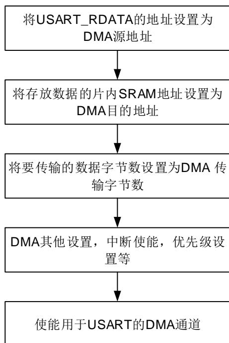
当 USART 接收到的数据数量达到了 DMA 传输数据数量，DMA 模块将产生传输完成中断。
