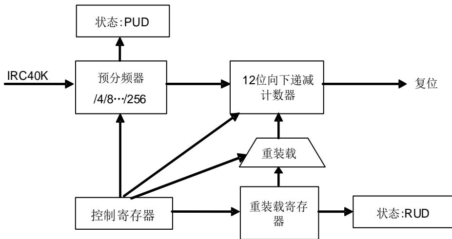
向控制寄存器（FWDGT\_CTL）中写0xCCCC可以开启独立看门狗定时器，计数器开始向下计数。当计数器记到0x000，产生一次系统复位。
