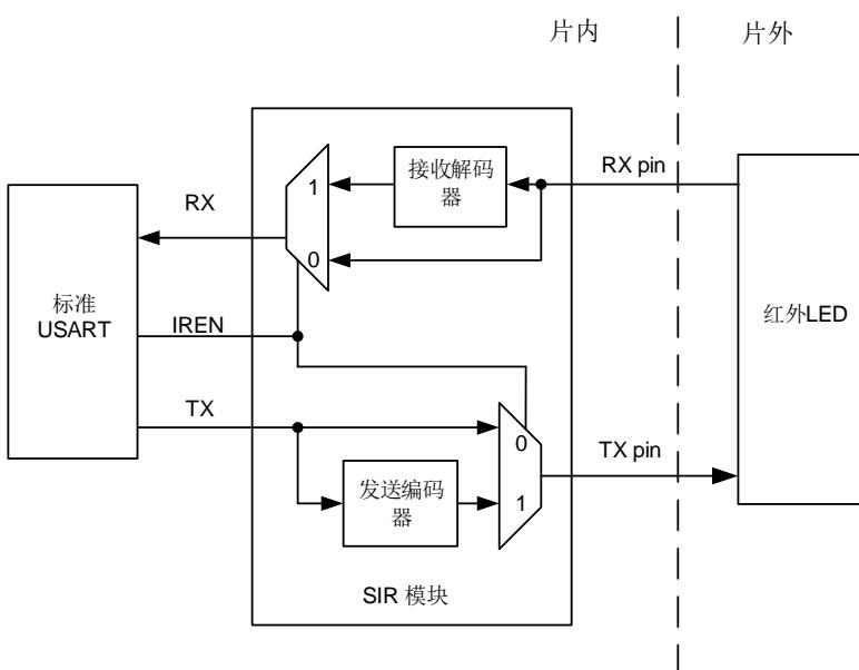
在 IrDA 模式下，TX 引脚与 RX 引脚电平不同。TX 引脚通常为低电平，RX 引脚通常为高电平。IrDA 引脚电平保持稳定代表逻辑 ‘1’，红外光源脉冲（RTZ 信号）代表逻辑 ‘0’。其脉冲宽度通常占一个位时间的 3/16。IrDA 无法检测到宽度小于 1 个 PSC 时钟的脉冲。如果脉冲宽度大于 1 但是小于 2 倍 PSC 时钟，IrDA 则无法可靠地检测到。
