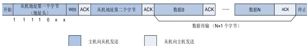
图 21-18. 7 位地址的 I2C 通讯流程（主机发送）
