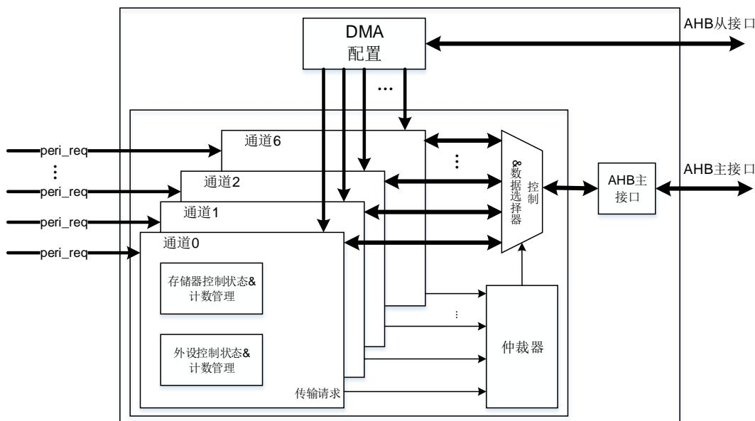
由 [图 11-1. DMA 结构框图](#) 所示，DMA 控制器由 4 部分组成：
