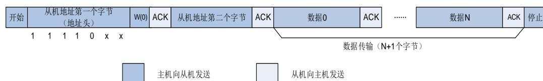
**图 21-8. 10 位地址的 I2C 通讯流程（主机接收）**
