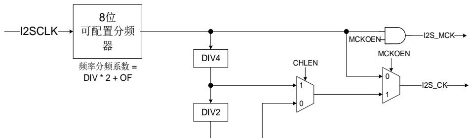
I2S 时钟生成器框图如 [图 22-51. I2S 时钟生成结构框图](#) 所示。I2S 接口时钟是通过 SPI\_I2SPSC 寄存器的 DIV 位, OF 位和 MCKOEN 位以及 SPI\_I2SCTL 寄存器的 CHLEN 位来配置的。时钟源是系统时钟 CK\_SYS 或 PLL2\*2。I2S 比特率可以通过 [表 22-7. I2S 比特率计算公式](#) 所示的公式计算。
