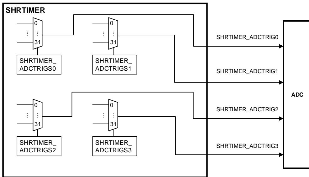
每个触发输出最多可以连接（逻辑或运算）32个事件。它们在 **SHRTIMER\_ADCTRIGSy** ( $y = 0..3$ ) 寄存器中定义。
