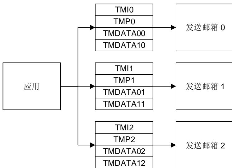
如果想要发送CAN-FD帧，使用发送邮箱x（x等于0到2）时，仅需要写对应的TMDATA0x（x等于0到2）寄存器。例如软件想要使用发送邮箱0发送64字节数据，需要通过写TMDATA00寄存器16次将待发送数据写入内部专用SRAM区。
