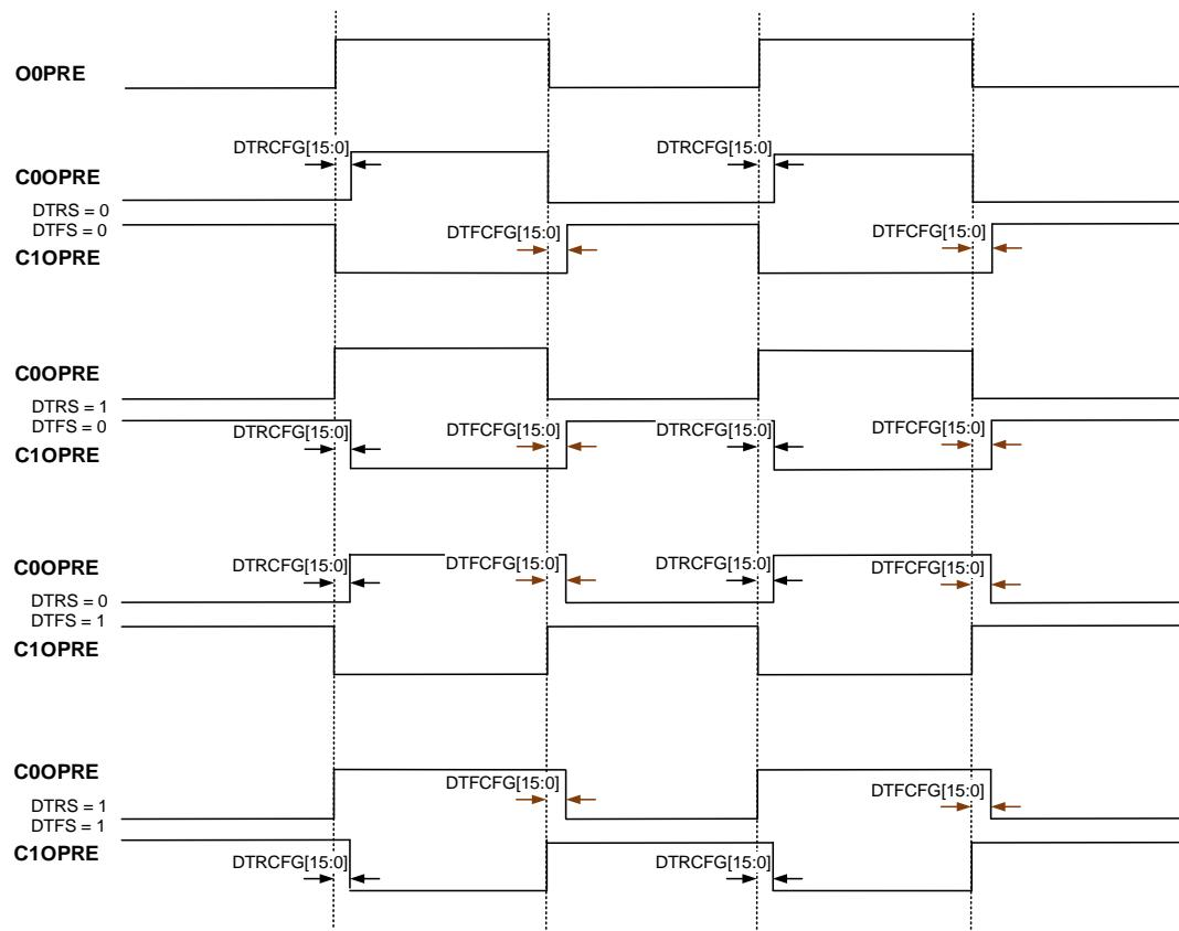
图 19-27. 脉宽小于死区时间时的互补波形展示了 OOPRE 脉冲宽度小于死区时间时的 C0OPRE 和 C1OPRE 互补波形。
