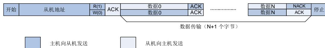
**图 21-7. 10 位地址的 I2C 通讯流程（主机发送）**
