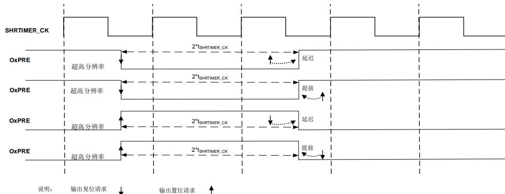
如果输出置位和复位请求的时间间隔大于两个完整的  $t_{HPTIMER\_CK}$  周期，则需要使用超高分辨率时钟。具体如图 19-23. 超高分辨率 OxPRE 波形所示。
