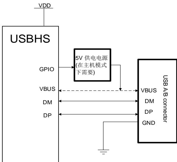
当USBHS工作在主机模式下时（FHM控制位置位、FDM控制位清除），VBUS为USB协议所定义的5V电源检测引脚。内部PHY不能提供5V VBUS电源，仅在VBUS信号线上具有电压比较器和充电、放电电路。所以，如果应用需要提供VBUS电源，那么则需要一个外部的供电电源IC。在主机模式下，USBHS和USB连接头之间的VBUS连接可以被忽略，这是由于USBHS并不检测VBUS引脚的电平状态，并假定5V供电电源一直存在。
